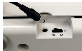
Abb. 27 Abziehen des zylindrischen Steckers
