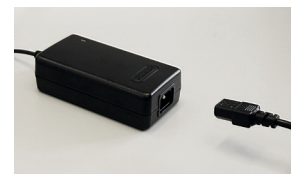
Abb. 28 Trennen des Netzkabels vom Netzteil
