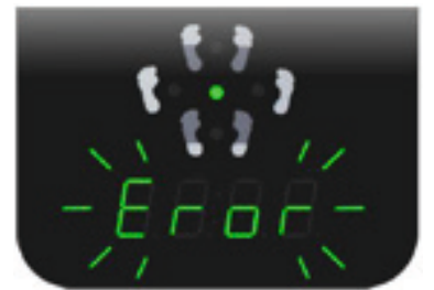
Abb. 37 Gerät beendet die Vibration und zeigt die Fehlermeldung an
