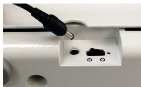
Abb. 4 Einstecken des zylindrischen Steckers
