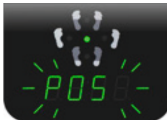
Abb. 30 Fehlermeldung „POS“ bei unebener Aufstellung
